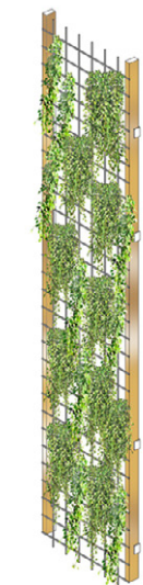
gevelopbouw groene gevel - Greens tech innovation grondgebonden systeem. Hedra gemixt met kamperfoelie. -> wordt groen aangeleverd
